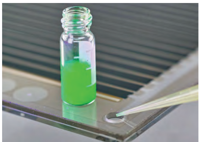
Großflächige, siebgedruckte Elektroden und Lotbahnen eines PeroTec™-Moduls auf Glas (links) und Befüllung eines PeroTec™-Moduls mit Perowskit-Lösung (rechts). Die Menge von 2 ml ist ausreichend für die Herstellung von 4 Quadratmetern Modulfläche.
