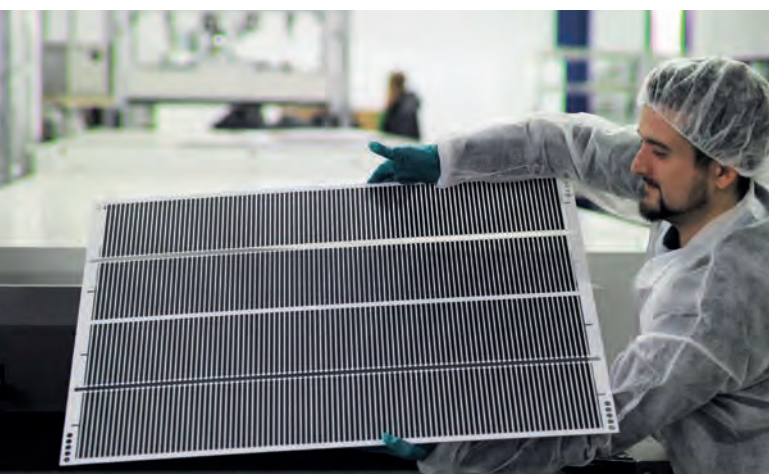
Großflächige, siebgedruckte Elektroden und Lotbahnen eines PeroTec™-Moduls auf Glas (links) und Befüllung eines PeroTec™-Moduls mit Perowskit-Lösung (rechts). Die Menge von 2 ml ist ausreichend für die Herstellung von 4 Quadratmetern Modulfläche.
