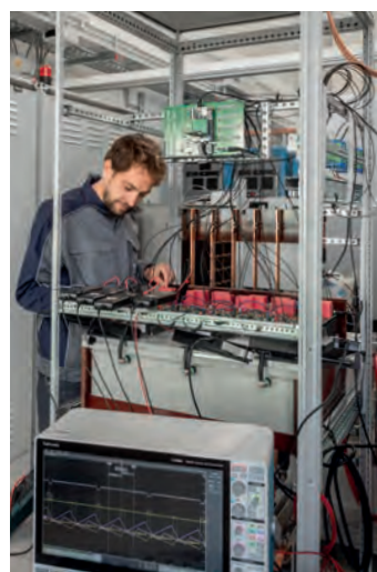
Aufbau und Test des SiC-Wechselrichter-Stacks in den Labors des Fraunhofer ISE.
