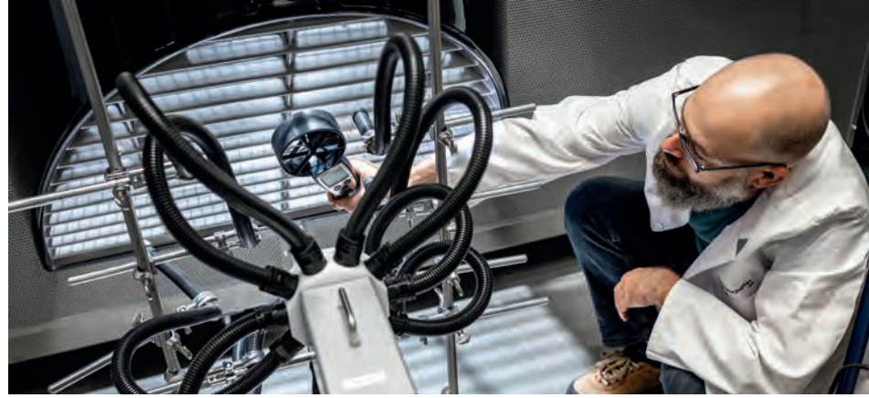
Messung der Lufttemperatur und -feuchte am Auslass einer außen aufgestellten Wärmepumpe.
