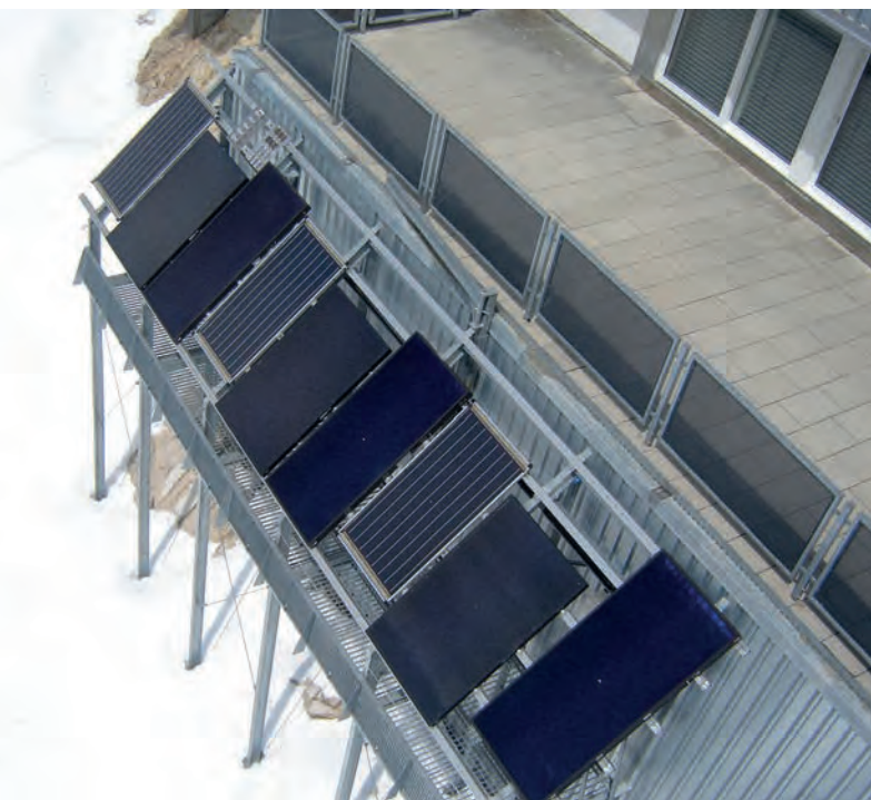
Teststand auf der Zugspitze in kaltgemäßigem Hochgebirgsklima mit Prüflingen aus dem Projekt.
