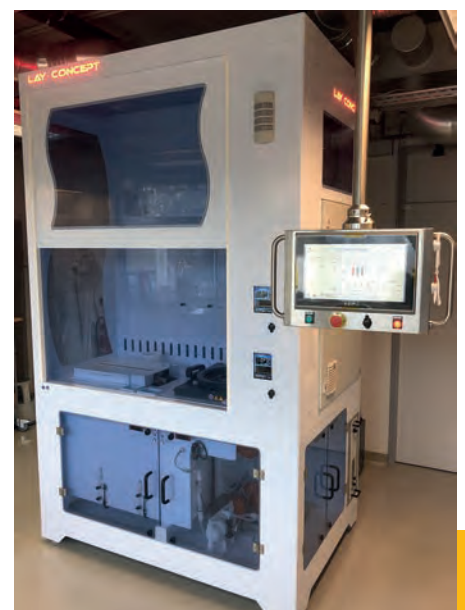
Elektrochemische Ätzbank mit Beleuchtungs- und Kühleinheit für Wafergrößen bis zu einem Durchmesser von 300 mm.
